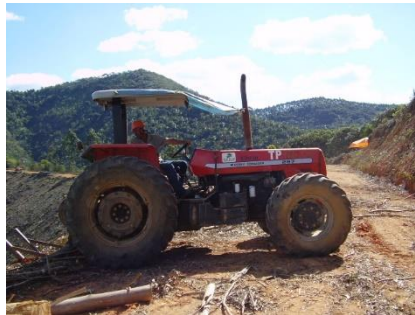
Figura 4 - Trator agrícola adaptado para extração de madeira.
