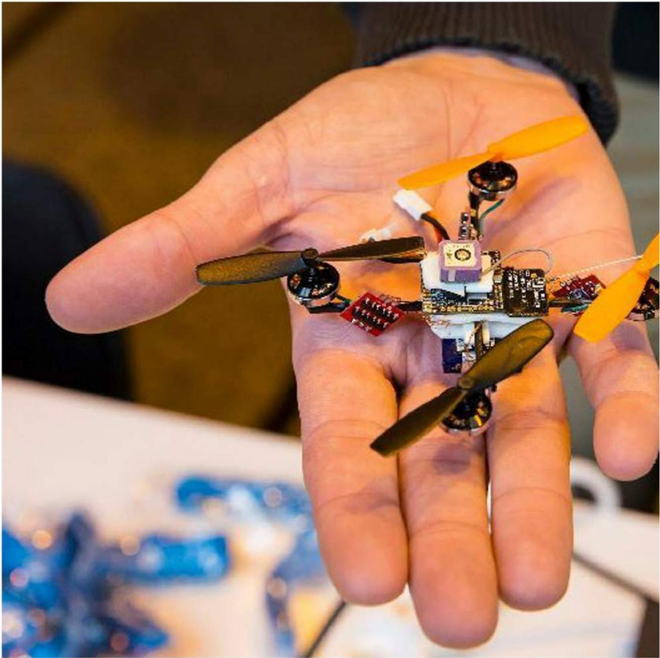
Figura 8.34: MAV-micro veículo aéreo .
