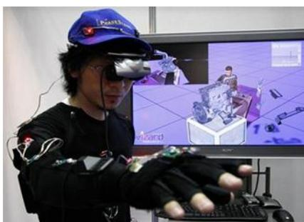
**Figura 23<sup>5</sup> - Funcionamento da imersão com uso de dispositivos especiais**
