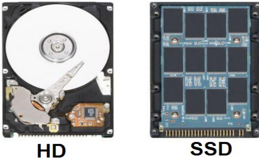
Figura 5 – Diferença física entre SSDs e HDDs.
