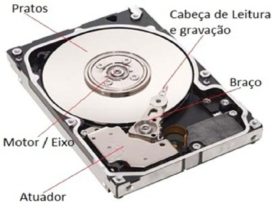
Figura 3 – Estrutura o Disco Rígido
