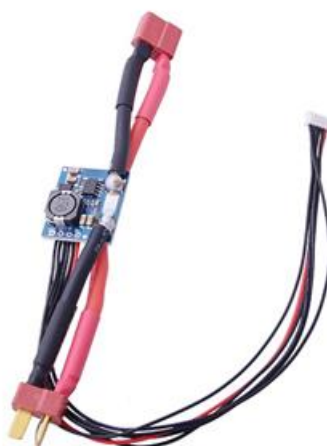
Figura 21 - Módulo de Alimentação.
