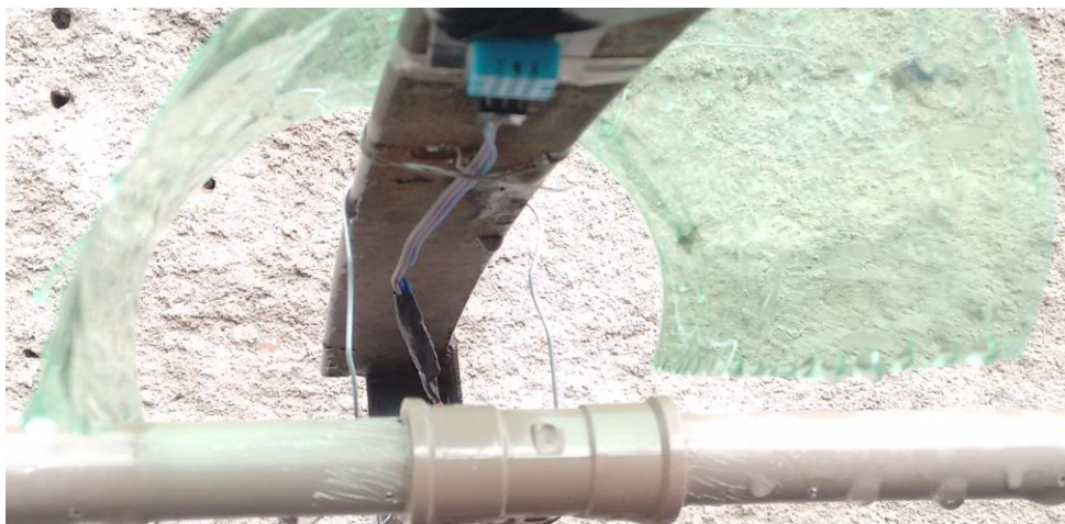
Figura 17: Implantação do sensor de umidade e temperatura (DHT11).
