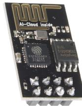
Figura 3: Módulo ESP-8266 v01
