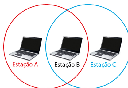
Figura 5: - Problema do terminal escondido
