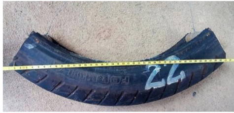
Figura 13: Armadilha Larvitampa confeccionada de pneu, medidas: 40cm de comprimento, 8cm de largura e 28cm de circunferência.
