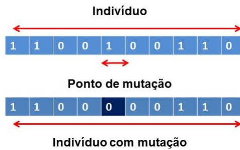
Figura 16 – Operador de Mutação
