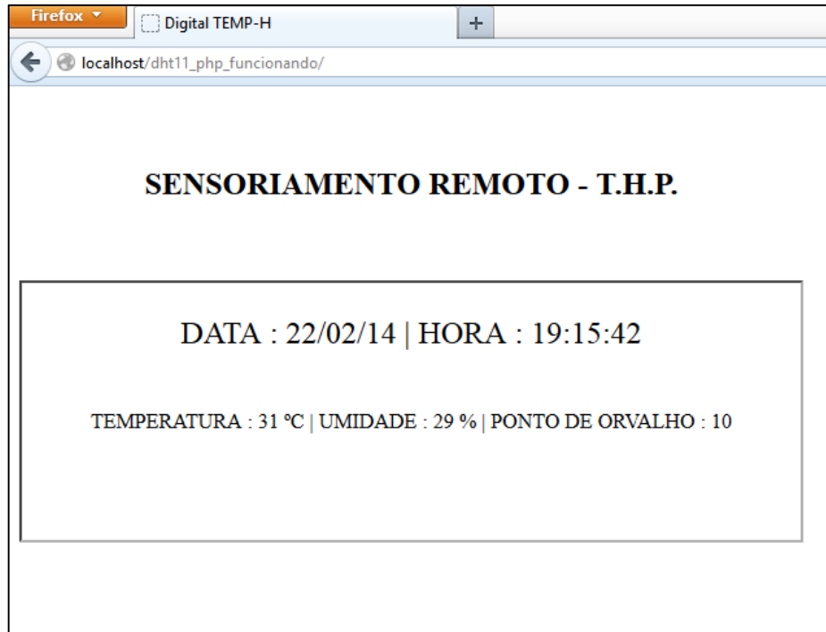
Figura 19 - Teste mostrando os dados capturado pelo sensor em uma aplicação PHP
