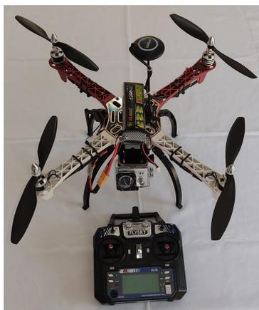
Figura 9 – VANT de modelo F-450 utilizado na captura das imagens - Fonte: O autor
