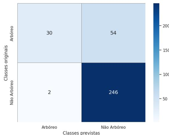
Figura 17 – Matriz de confusão do experimento 3 com a *MobileNetV2* - Classificação de Arbóreo e Não Arbóreo - Fonte: O autor
