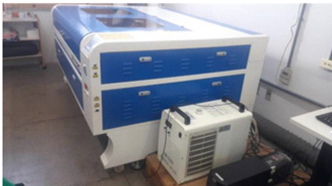
Figura 3 - Máquina de corte a laser de 130 W
