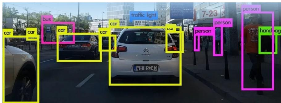
Figura 8 – Exemplo de Detecção - YOLOv8
