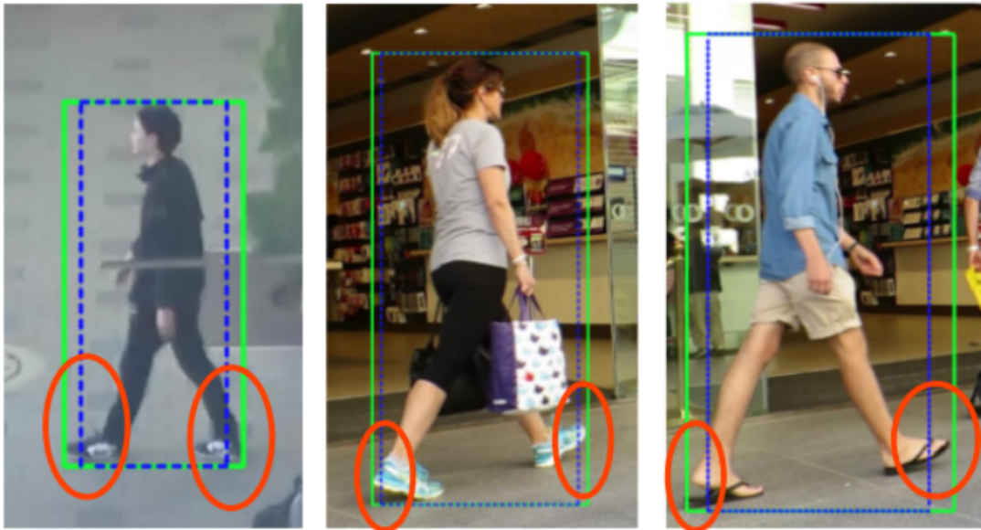
Figura 3 – Comparação da forma da caixa delimitadora entre o filtro de Kalman tradicional (em azul tracejado) e o filtro proposto pelo BoT-SORT (em verde). O filtro proposto resulta em melhor ajuste da caixa ao objeto. Os círculos em vermelho destacam a região dos pés, evidenciando que o BoT-SORT consegue acompanhar com mais precisão o contorno do corpo durante a locomoção. Imagem adaptada do trabalho de ( AHARON; ORFAIG; BOBROVSKY , ).
